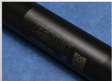
ZERO POINT SHAFTの表面処理は三層の特殊メッキ。第一層の“無電解ニッケルメッキ”は寸法精度管理に優れるため、設計通りの正確な寸法管理が可能です。また、対象物全体に対して均一に処理されるので、一般的な電気メッキでは不可能な円筒の内側のメッキ処理が可能で。第二層の“黒クロームメッキ”は、表面にナノレベルの凹凸を作り、油分の保持性を向上させます。シックなブラックカラーも魅力です。第三層はZERO POINT SHAFTだけの特殊メッキ処理を使用し、今までにない高いレベルの耐久性を実現しています。
