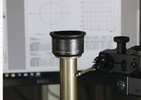
P.E.O.では自社内に「真円度・円筒形状測定機」を備えています。製品開発や品質管理では、10,000分の1mm単位の精密計測を行い、最高品質、最高性能のアクスルシャフト製造を目指しています。
